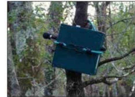
Figure 263 : Station fixe d'enregistrement automatique des signaux de chiroptères avec système SM2BAT. Le dispositif est fixé sur un arbre. (ECOSPHERE, 2014)
